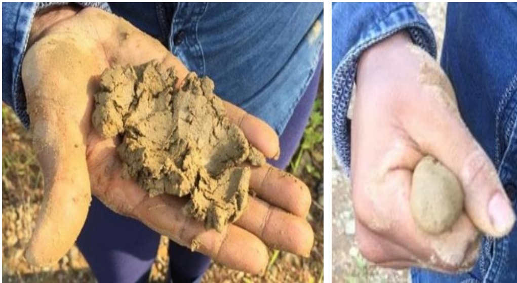
Imagen 2-3. Proceso de identificación del tipo de suelo en el área de estudio, mediante el método de la textura al tacto
