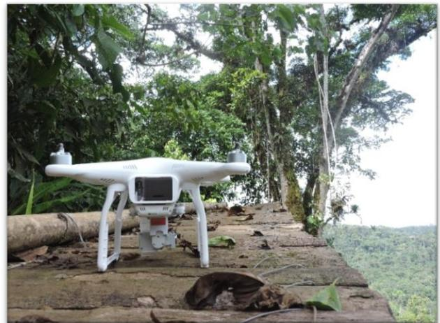
Fotografía 10: Drone DJI Phantom 3 Pro
