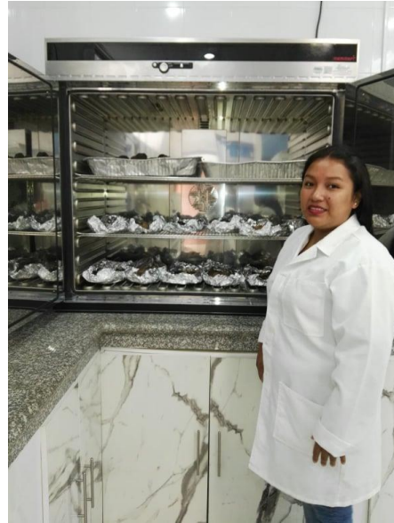
Foto 2. Colocación de muestras de ensilado en la estufa para su posterior análisis.
