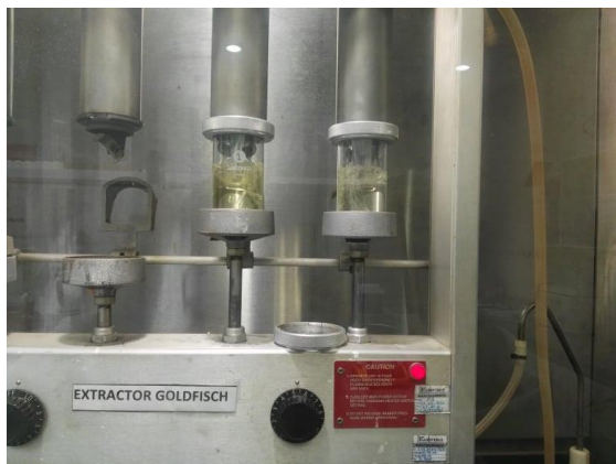
Foto 7. Determinación de EE del ensilado
