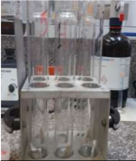
Foto 7. Extracción de proteína de muestras de excretas por el método Kjeldahl
