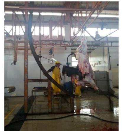
**Figura 11.**Desollado Mecánico
