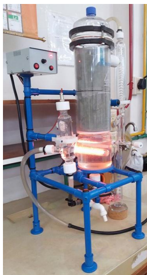
Figura 1. Equipo extractor de aceites esenciales FIGMAY® (Argentina).
