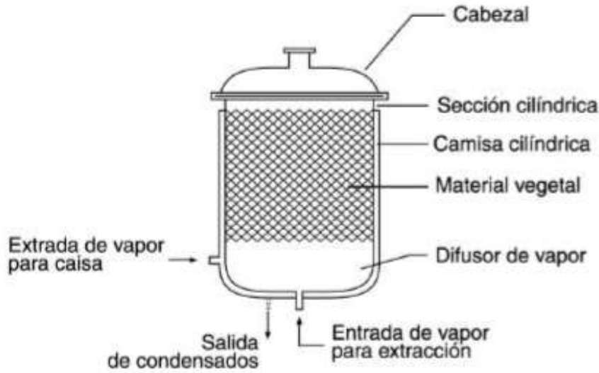
Figura 3. Esquema de un extractor tradicional. Obtenido de Bandoni (2003).
