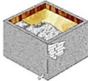
Figura 9. Tanque de fermentación
