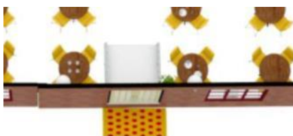
Figura 13 Piso podotáctil ingreso al restaurante
