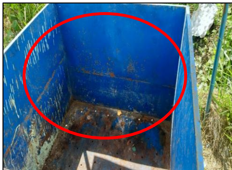
Ilustración 23: Degradación de la Estructura de los Contenedores.
