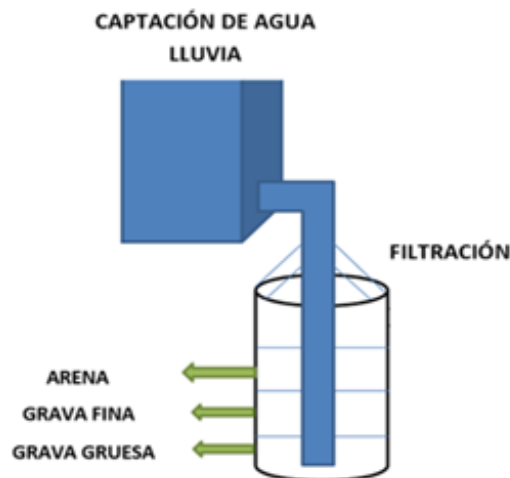
Imagen 9. Construcción del filtro
