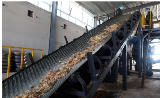
Ilustración 27: Cinta de transporte de restos de residuos orgánicos destinados a la planta de cucarachas
