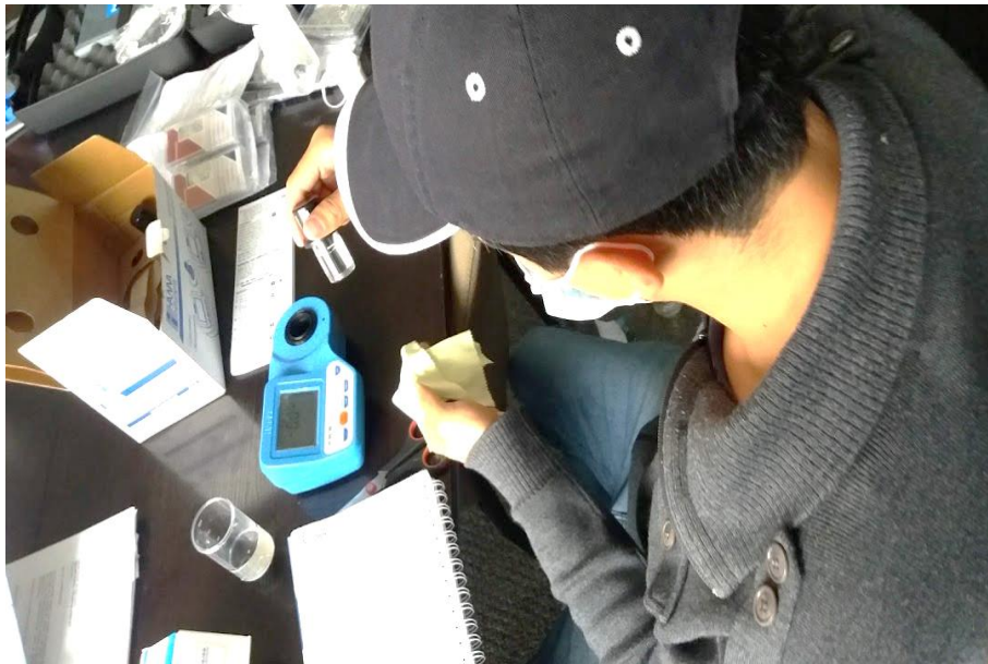
Gráfico 6. Determinación de los Nitratos en las muestras del agua.
