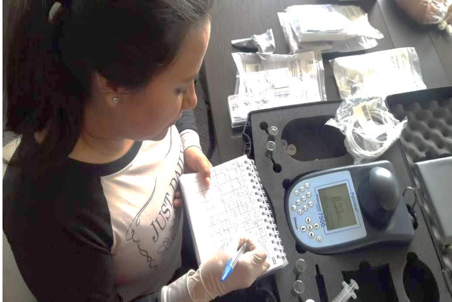
Gráfico 7. Determinación de los Fosfatos en las muestras de agua.
