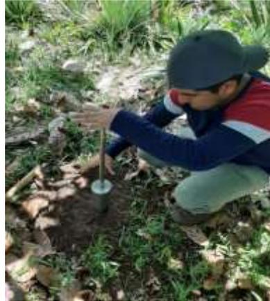
**Anexo 4.** Obtención de muestras en campo con cilindros de 5 cm de altura y 5 cm de diámetro.
