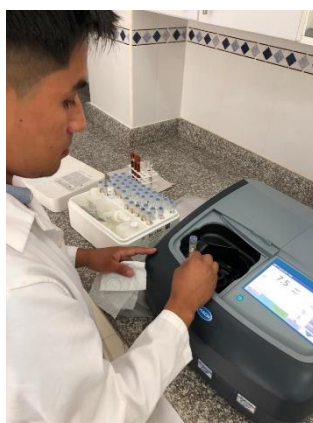
Fotografía N°6: Análisis de DQO y Fósforo
