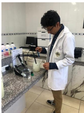
Fotografía N°5: Multiparamétrico para pH y conductividad
