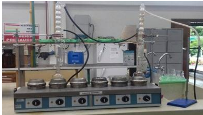
Grafico 3. Equipo Soxhlet para extracción de aceites.
