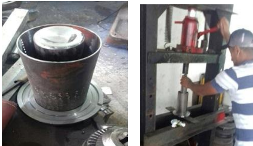
Grafico 4: Construcción de la prensa hidráulica con material reciclable.
