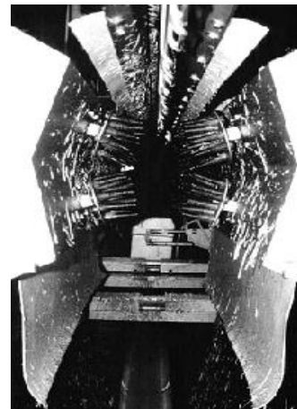
Figura 4 Vista transversal de la cámara de pelado en una línea automática.
