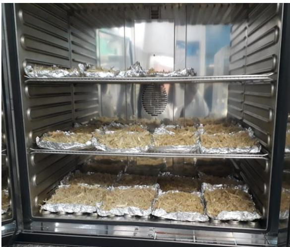
*Ilustración 1 Secado del bagazo de Caña de azúcar.*
