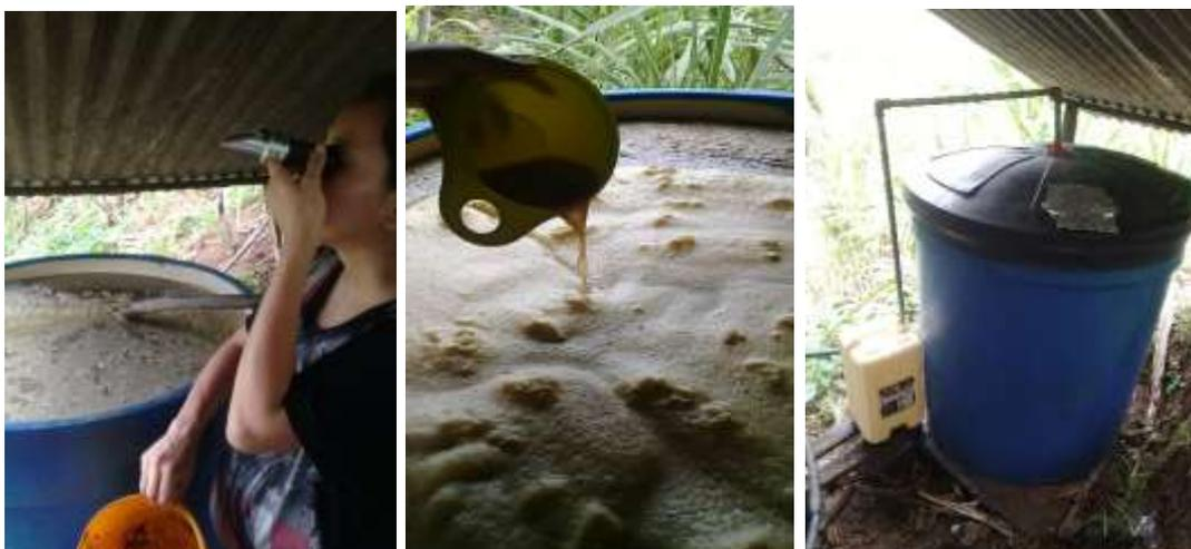
**Anexo 7.** Control de temperatura en el proceso de destilación por medio de un termómetro infrarrojo a nivel de destilería.
