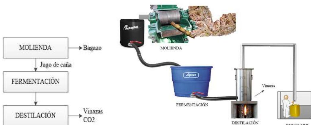
Figura 6. Proceso de obtención de etanol en la destilería "Riviera Revilla Fray Ángel"
