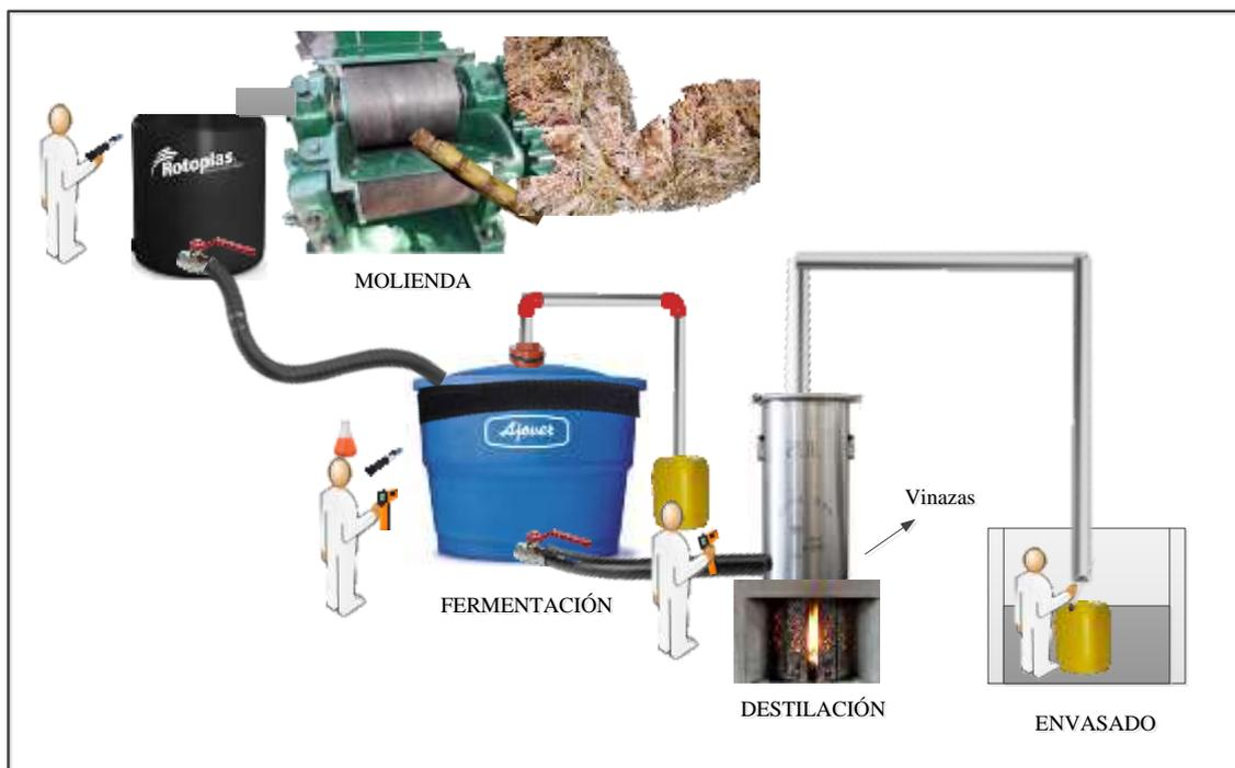
Figura 7. Proceso de obtención de etanol en la destilería “Rivera Revilla Fray Ángel”, con las modificaciones tecnológicas operacionales y de equipamiento.
