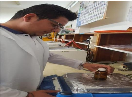
**Fotografía 7:** Agitación mecánica de la muestra
