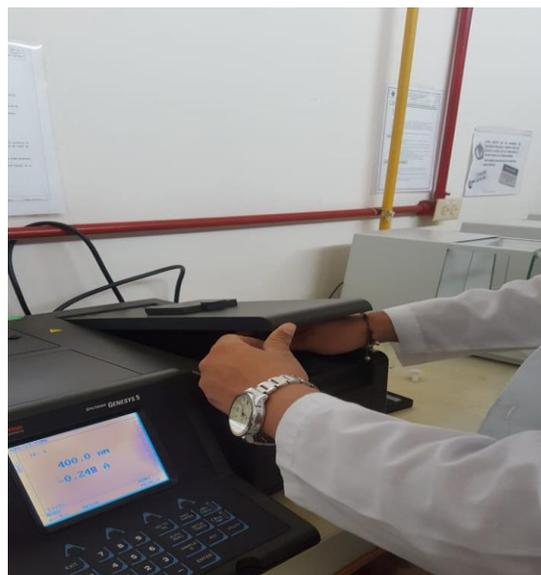
**Fotografía 27:** Lectura de la absorbancia en el espectrofotómetro
