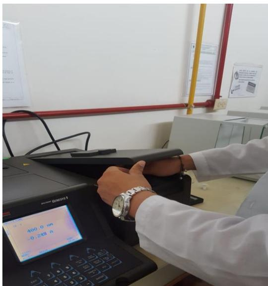
**Fotografía 18:** Lectura de la absorbancia en el espectrofotómetro
