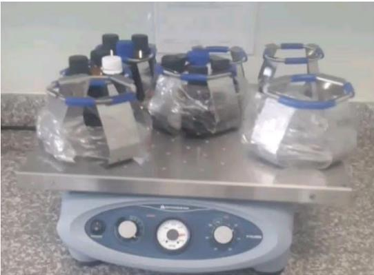
**Fotografía 12:** Agitación mecánica de la muestra
