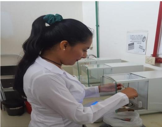
**Fotografía 21:** Pesado de la masa del absorbente (Ceniza de cáscara de arroz)
