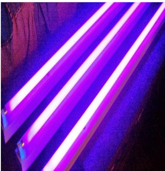
**Fotografía 26:** Lámparas UV-C de 40w para la oxidación avanzada
