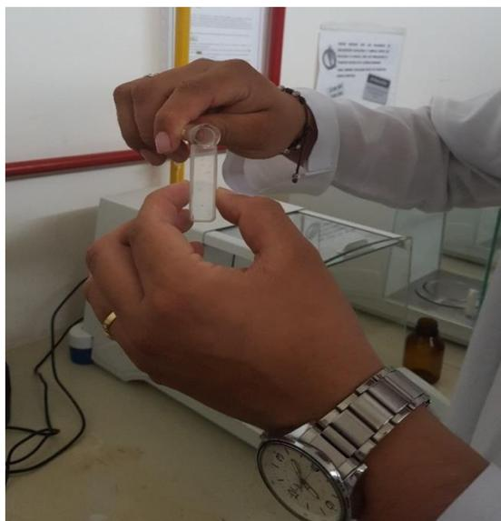
**Fotografía 4:** Lectura de la absorbancia en el espectrofotómetro en cubetas de cuarzo
