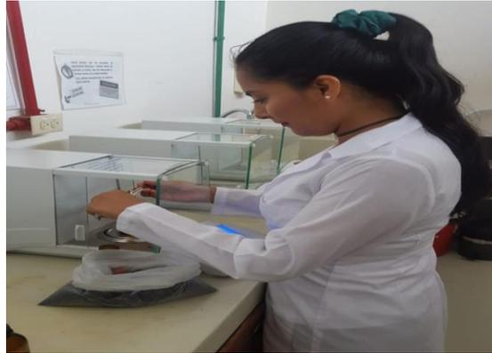
**Fotografía 6:** Pesado de la masa del absorbente (Ceniza de cáscara de arroz)
