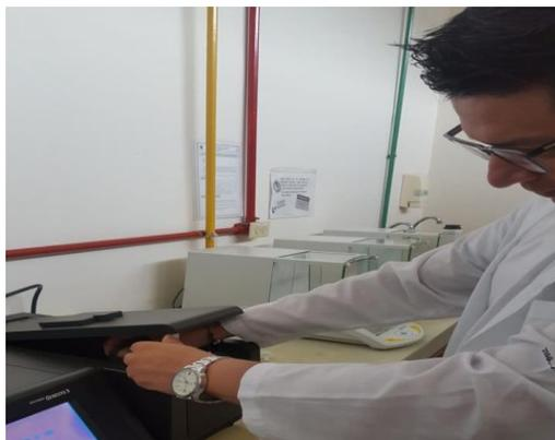
**Fotografía 14:** Medición de la concentración del contaminante en el espectrofotómetro
