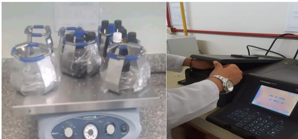
**Fotografía 23:** Agitación mecánica de las muestras por 90 minutos y medición de la concentración del contaminante en el espectrofotómetro
