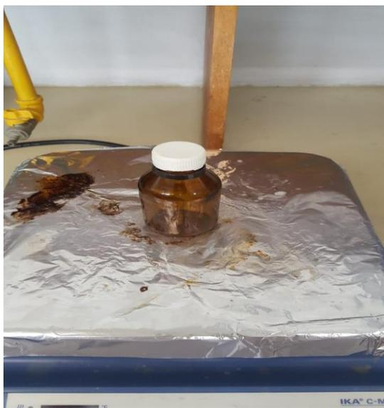
**Fotografía 16:** Agitación mecánica de las muestras a diferentes tiempos
