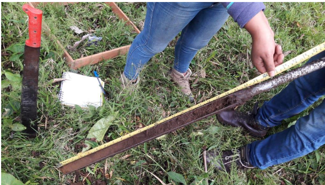
Anexo 7.3. Muestreo de suelo de 0-50 cm con el barreno en la zona de recarga hídrica de Huagrayacu.
