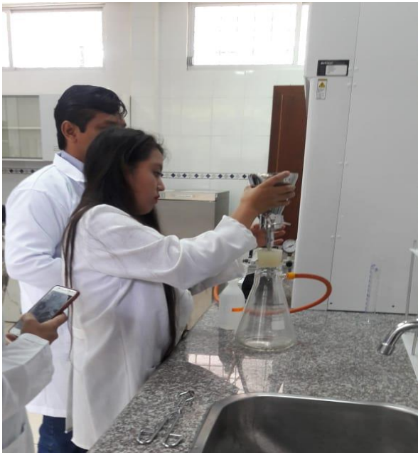
Anexo 7.1. Análisis de sólidos suspendidos en laboratorio ambiental de la Universidad Estatal Amazónica.
