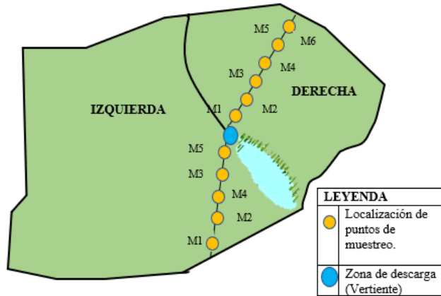
Figura 3. Esquema de muestreo según el método de líneas de intercepción para el estudio de la zona de recarga.
