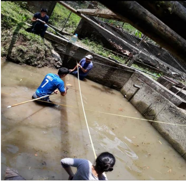
Anexo 7.1. Medición de la sedimentación presente en el embalse de la zona de recarga hídrica.
