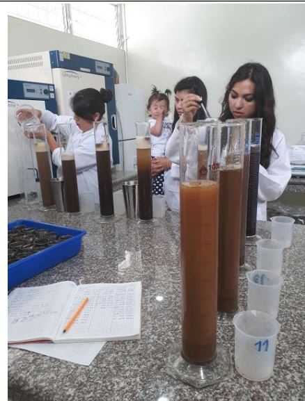
Foto 8: Determinación de textura del suelo
