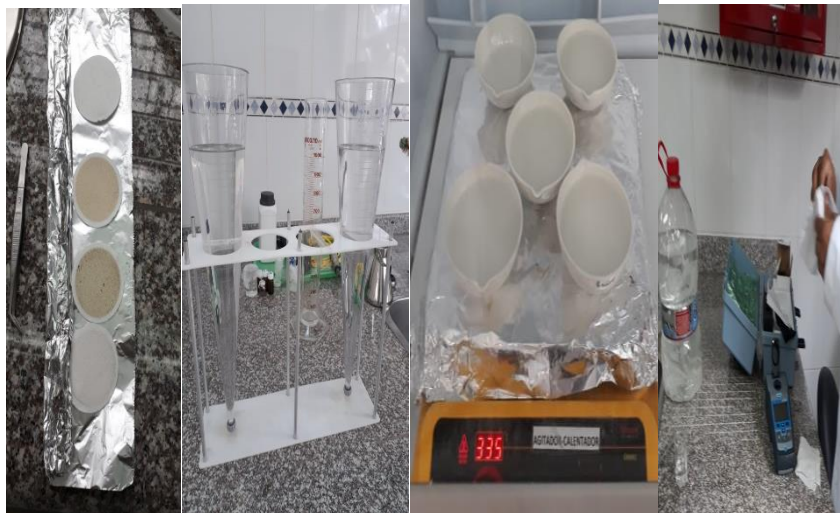
Foto 11: Análisis de ICA, para determinar los sólidos disueltos, suspendidos y sedimentables.
