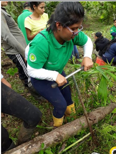
Foto 7: Recolección de las muestras con el barreno
