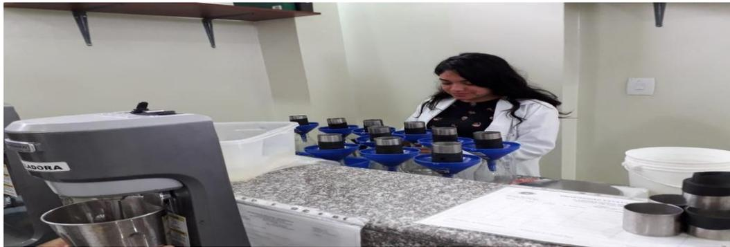
**Anexo 9:** Se observa la toma de datos de la muestra de las propiedades físicas en el laboratorio de la UEA de la conductividad hidráulica del suelo de la parroquia Madre tierra.
