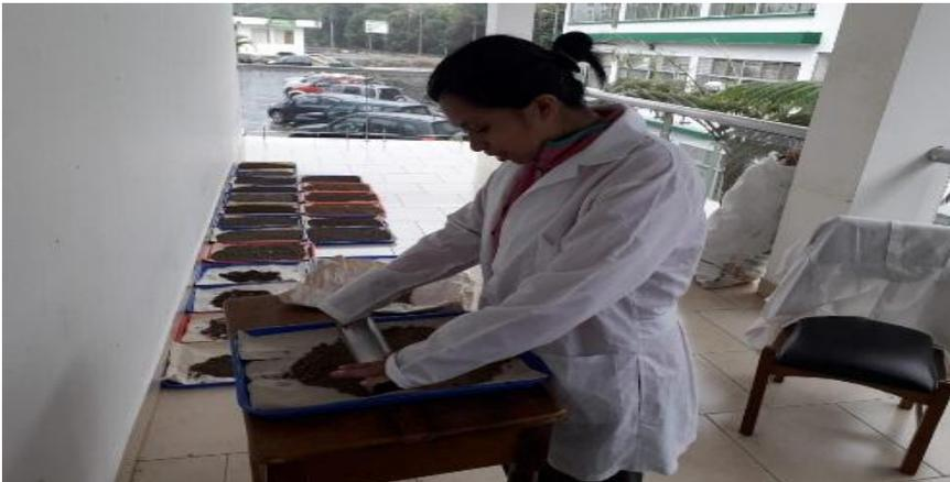
**Anexo 5:** Tamizado de las muestras alteradas en el laboratorio de la UEA.
