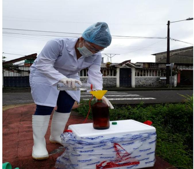
**Imagen 2.** Colocación de muestra simple en frasco ámbar de 1000mL.
