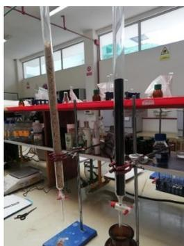
**Fotografía 14.** Bagazo de caña y ceniza de arroz en columnas de vidrio.
