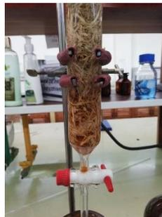
**Fotografía 15.** Cambio de color del lixiviado al pasar por el bagazo de caña
