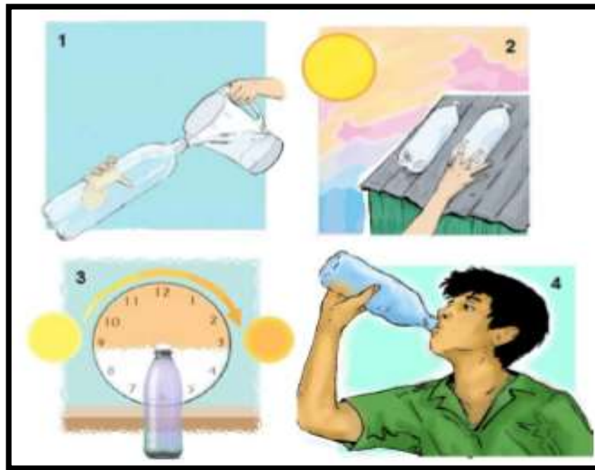
Ilustración 2: Descripción gráfica del método SODIS
