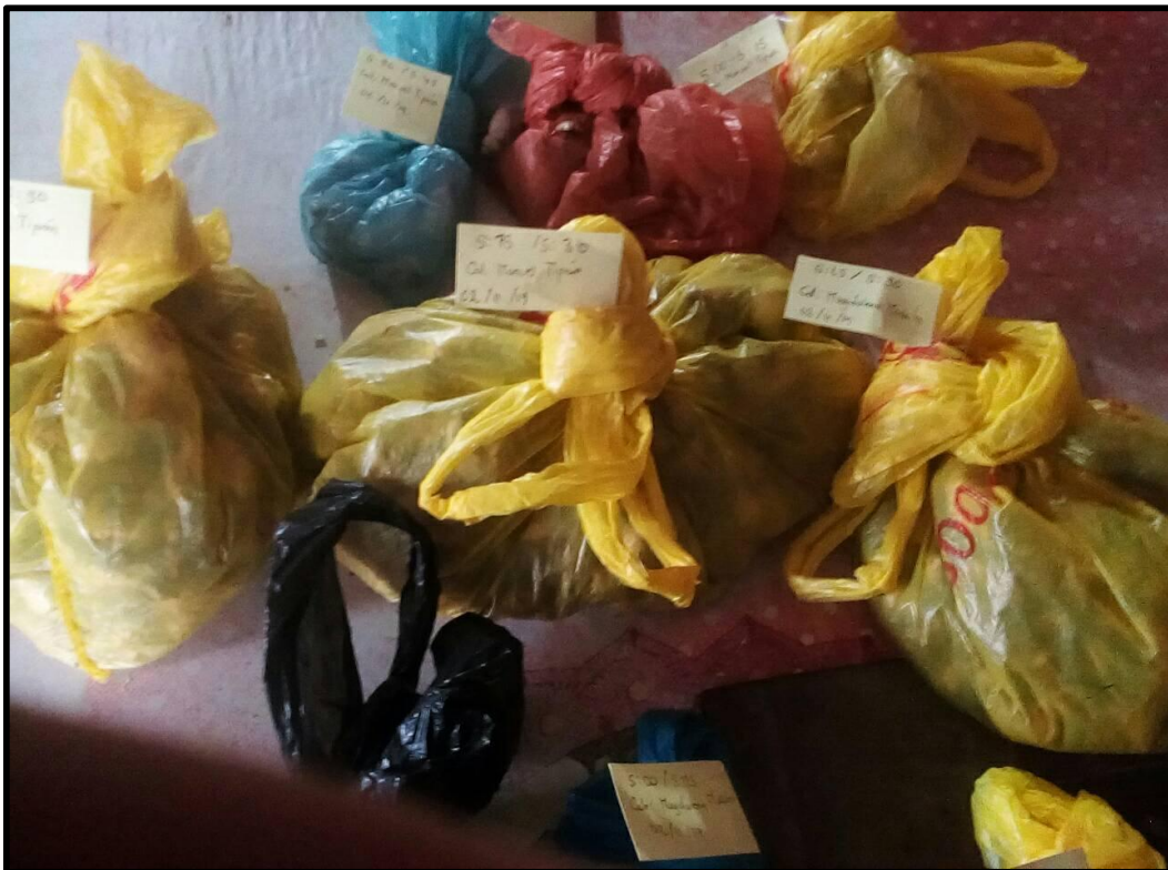
Imagen 5. Muestras registradas y etiquetadas de acuerdo a la fecha, hora, muestreador y punto de muestreo.
