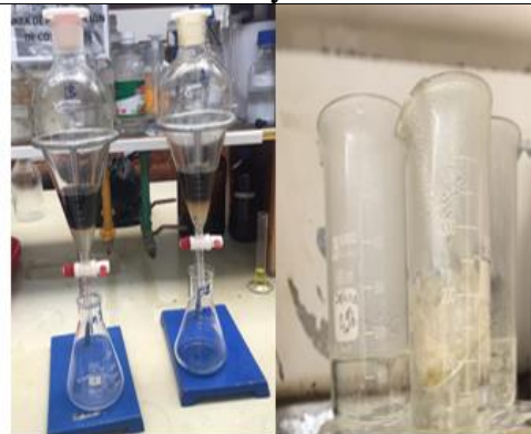
Ilustración 4. Desprendimiento de cafeína con cloroformo y evaporación del cloroformo
