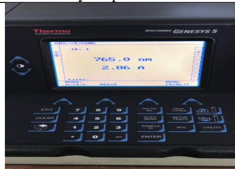
Ilustración 6. Lectura de la absorbancia en el espectrofotómetro
