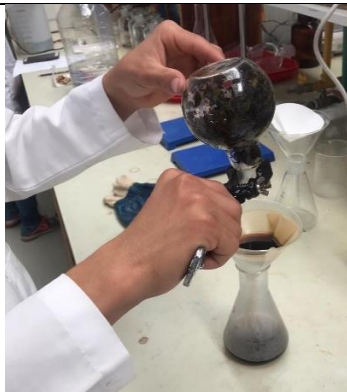
Ilustración 3. Filtrado del extracto acuoso de la guayusa en Caliente
