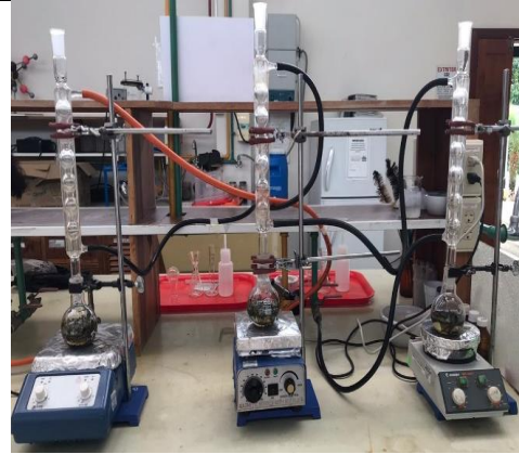
Ilustración 2. Proceso de Decocción de Guayusa
