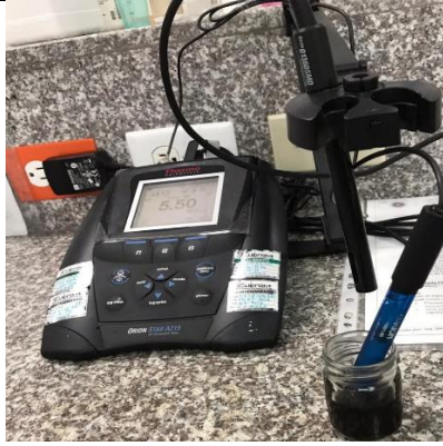
Ilustración 9. Medición de pH de producto final (I. Guayusa)
