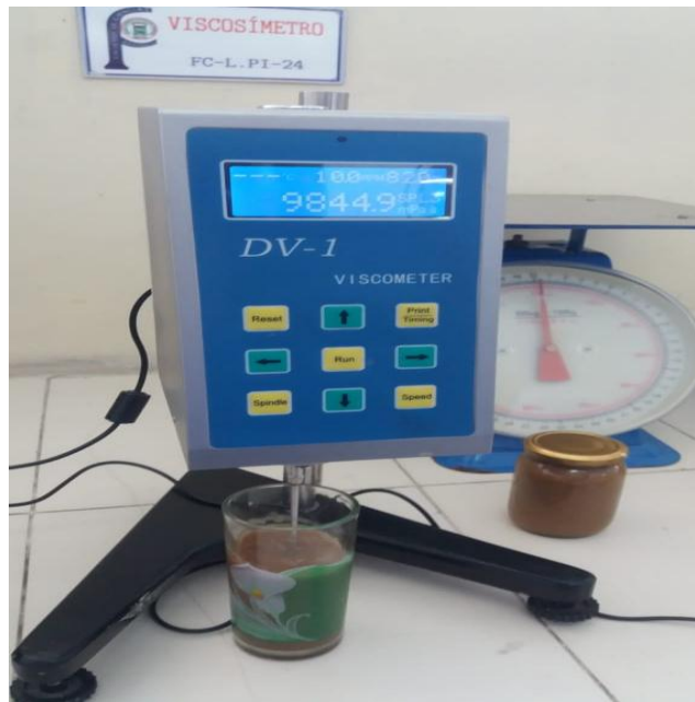
Figura 12. Determinación de Viscosidad del concentrado de mucílago de café Fuente: Guamán J & Lucero
