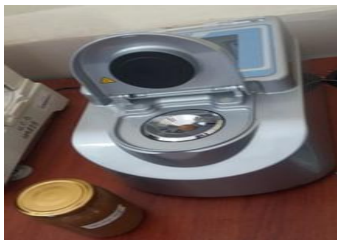
Figura 11. Determinación de grados °Brix del concentrado de mucílago de café Fuente: Guamán J & Lucero F
