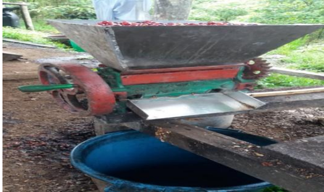
Figura 5. Despulpado del grano de café Fuente: Guamán J & Lucero F
