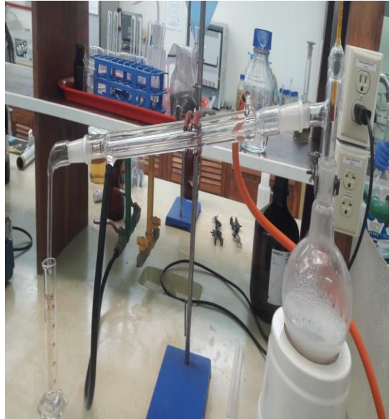
Imagen 18: Destilación de muestras de 250 ml de mosto
