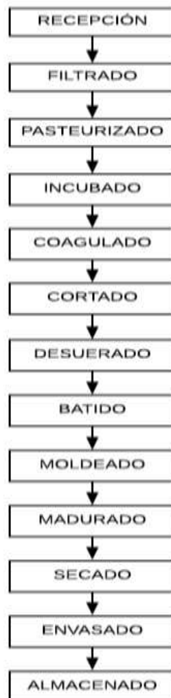
Figura 4. Diagrama de bloques para la elaboración de queso madurado en tres tipos de salmuera. Fuente: Saltos R y Romero M, 2019
